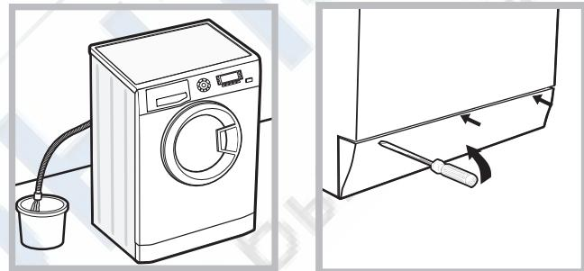
2. проверьте, чтобы уровень воды в машине был ниже отверстия люка. В противном случае слейте излишки воды через сливную трубу в ведро, как показано на схеме.
